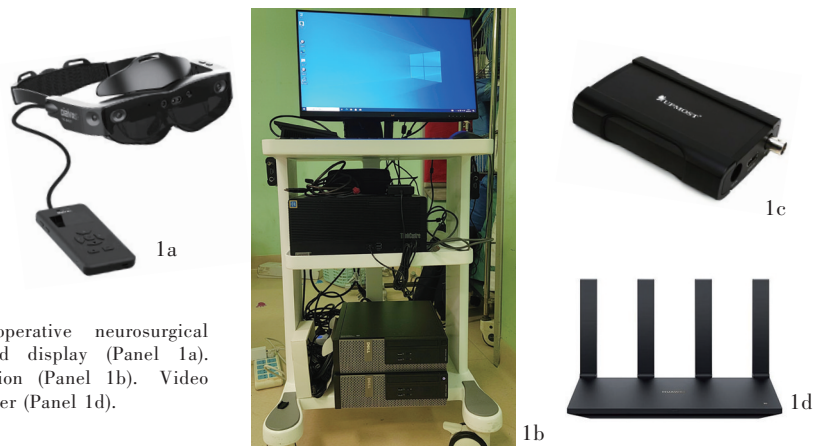
图 1 基于混合现实技术的多模态头戴式神经外科术中监测系统硬件组成 1a 穿透式头戴式显示器 1b 集成式视频处理工作站 1c 视频采集器 1d 无线路由器
